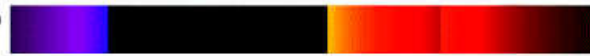
Spectre de la lumière blanche ayant traversé la solution aqueuse de permanganate de potassium
