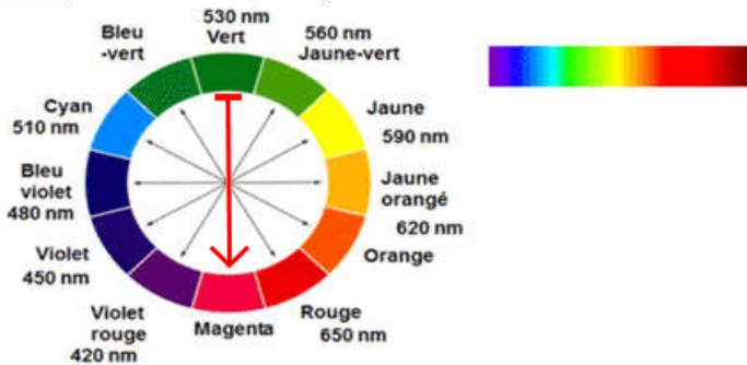
Q5: A quelle longueur d'onde  $\lambda$  doit-on régler un spectrophotomètre afin de réaliser une courbe d'étalonnage  $A = f(C)$  pour la solution de permanganate de potassium \*
