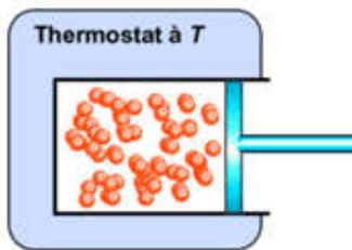
Une quantité  $n_1 = 0,320$  mol d'un gaz supposé parfait est maintenue dans une enceinte thermostatée à la température T et de volume  $V = 2,50$  L. La pression mesurée est  $P = 3,25$  atm
