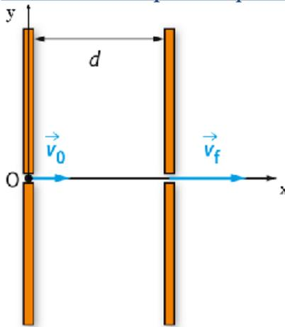
Un proton pénètre dans un condensateur plan constitué de 2 armatures avec une vitesse initiale perpendiculaire aux armatures. Dans ce condensateur plan règne un champ électrique uniforme  $E = 2,0 \text{ kV/m}$ . **Le proton subit une accélération.**
