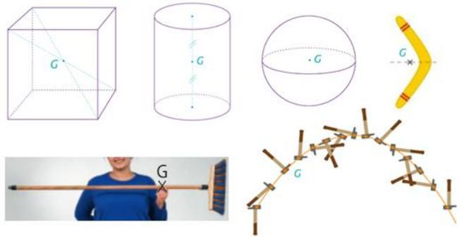
Si le **système est homogène** alors le centre de masse se situe **au centre de symétrie**..... du système.
