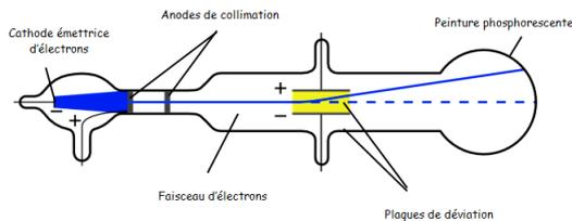
Tube utilisé par Thomson pour montrer la déviation de particules chargées par un champ électrostatique :
