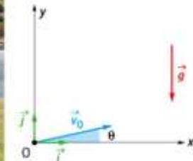
Une balle de golf de centre de masse G et d'une masse de 46 g est lancée au niveau du sol avec une vitesse initiale  $v_0$  faisant un angle  $\theta$  par rapport à l'horizontale.
