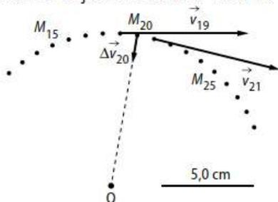
La construction de  $\Delta \vec{v}_{20}$  permet de déterminer les caractéristiques de  $\vec{a}_{20}$  :
