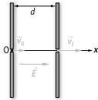
D'après le schéma de l'énoncé,  $v_f > v_0$ , donc l'armature de droite est chargée négativement pour accélérer le proton. Ainsi, le champ  $\vec{E}$  est orthogonal aux plaques et orienté vers l'armature négative ( $x$  croissant).
